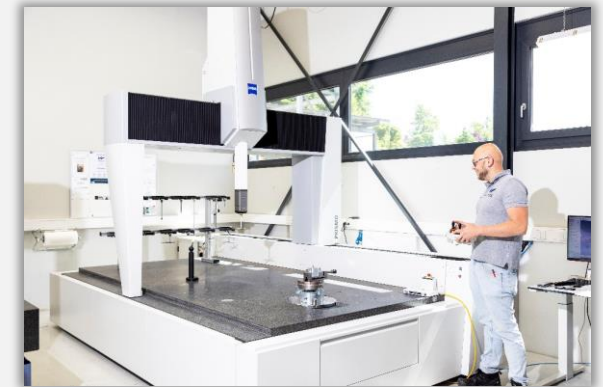
Prüfung klimatisierter Messraum mit 2 KMM
