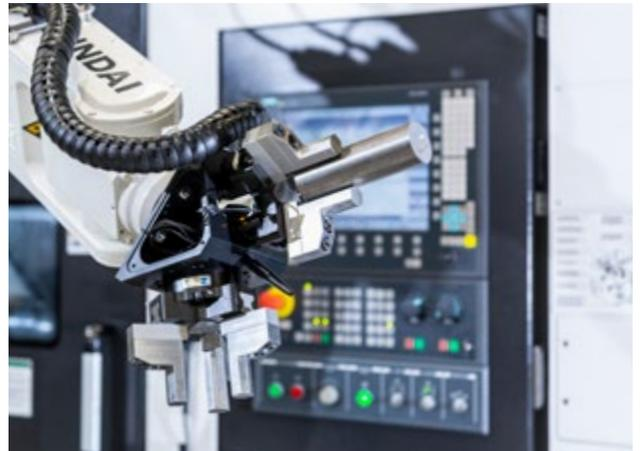
Doppelgreifer für schnelle Werkstückwechsel
