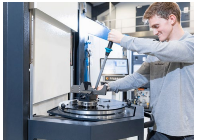
Hauptzeitparalleler Rüstplatz ergonomisch ausgeführt und mit mechanischer Verriegelung für maximale Sicherheit.
