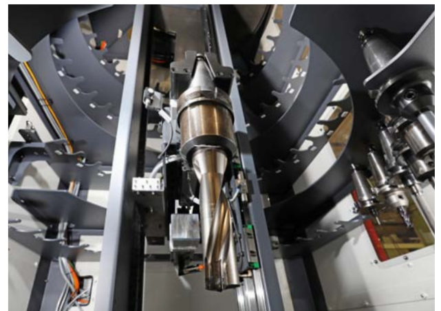
Das Werkzeug immer im Griff: die Greifer können auf Wunsch auch verschiedene WZ-Aufnahmen gleichzeitig handhaben
