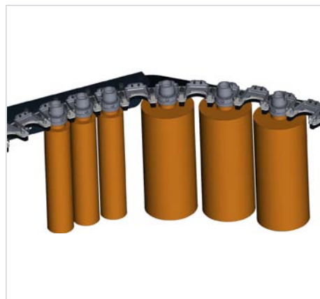
Aufteilung für HSK63, PSC 63, SK40, BT40: Links: Standarddurchmesser bis 80 mm Rechts: Durchmesser bis 160 mm bei freien Nebenplätzen
