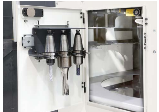
Ergonomische Beladeluke für bis zu 3 Werkzeuge gleichzeitig
