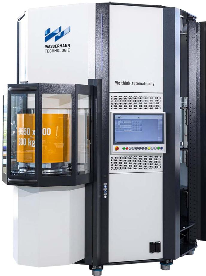
Paletten-TERMINAL WORK-S mit 4 Ebenen und bis zu 27 Palettenplätzen (Ø 550 mm)
