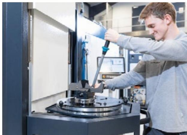
Hauptzeitparalleler Rüstplatz ergonomisch ausgeführt und mit mechanischer Verriegelung für maximale Sicherheit.
