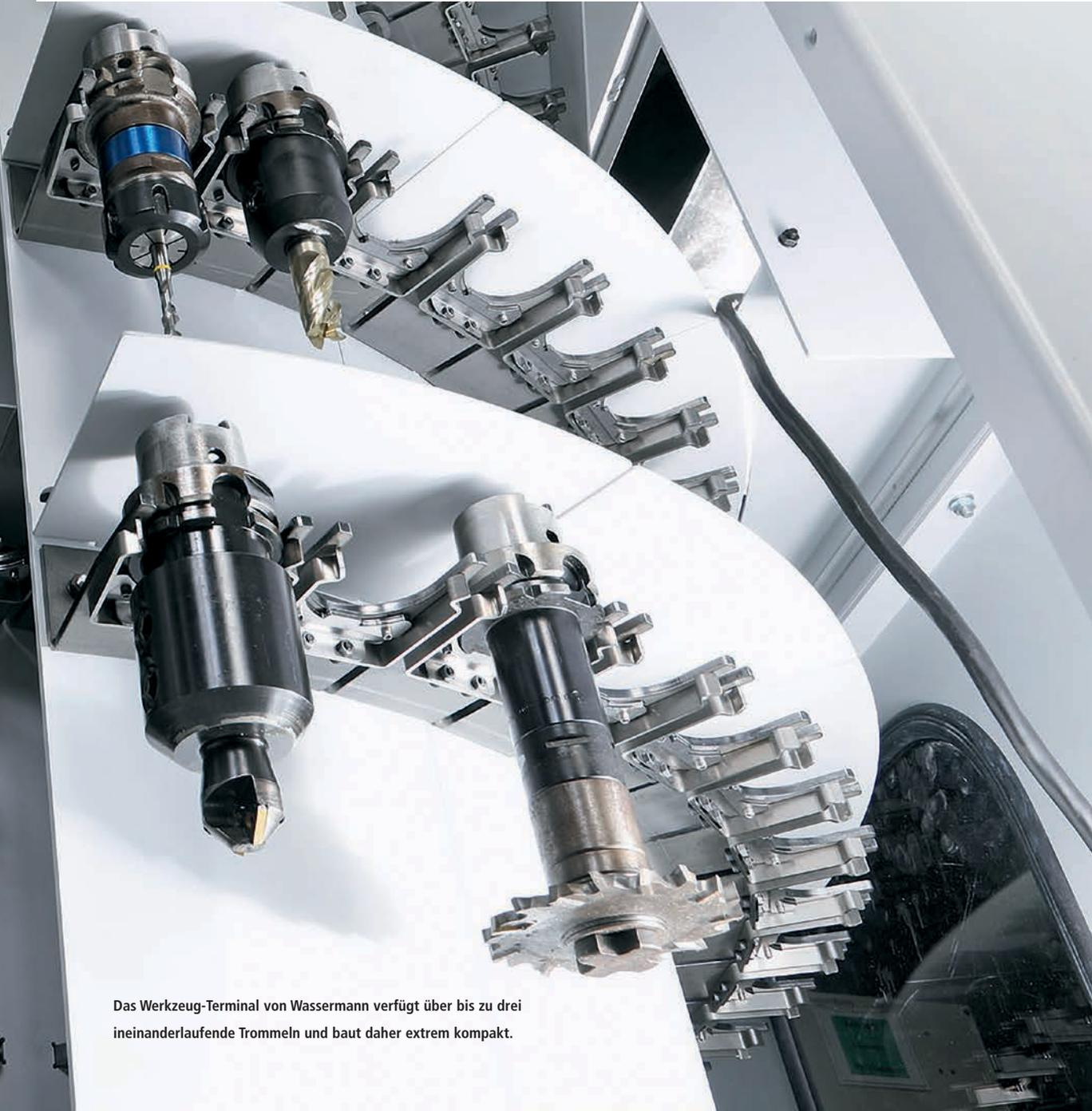
Das Werkzeug-Terminal von Wassermann verfügt über bis zu drei ineinanderlaufende Trommeln und baut daher extrem kompakt.
