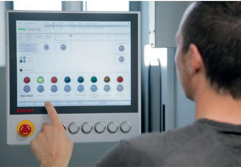
Das Multitouch-Control-Panel CP3915 mit Tastererweiterung trägt mit seinem modernen und ansprechenden Design zur hochwertigen Erscheinung des Werkzeugmagazins bei.
